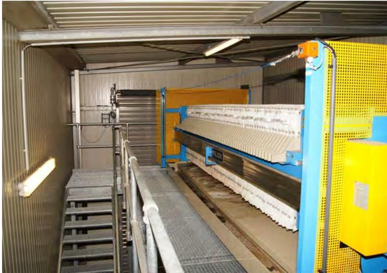
Abbildung 2.7: Kammerfilterpresse zur Gewinnung des P-angereicherten, sauren Filtrats
