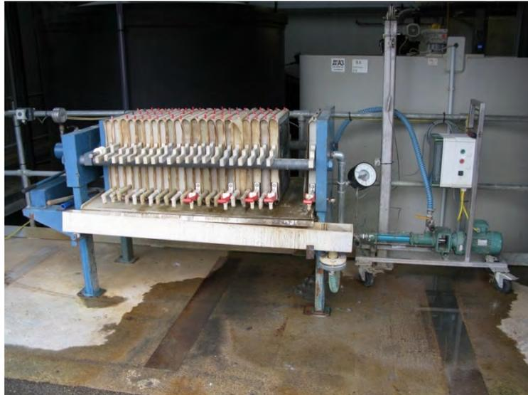
Abbildung 3.23: Halbtechnische Kammerfilterpresse mit Exzentrerschneckenpumpe
