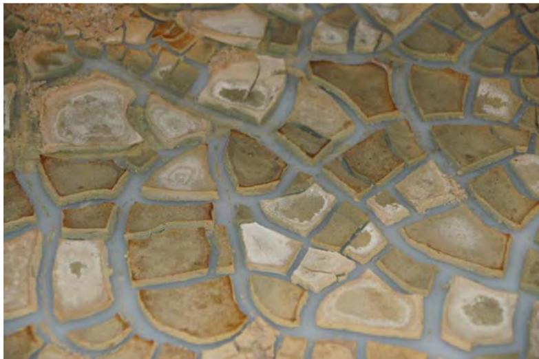
Abbildung 2.10: MAP-haltiger Schlamm - frisch und in verschiedenen Trocknungsstadien
