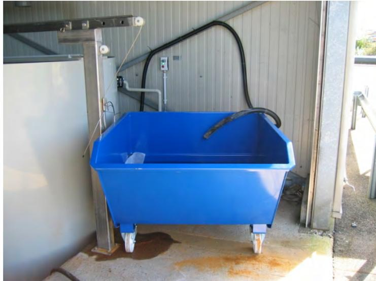
Abbildung 3.20: Entwässerungscontainer zur Produktentnahme
