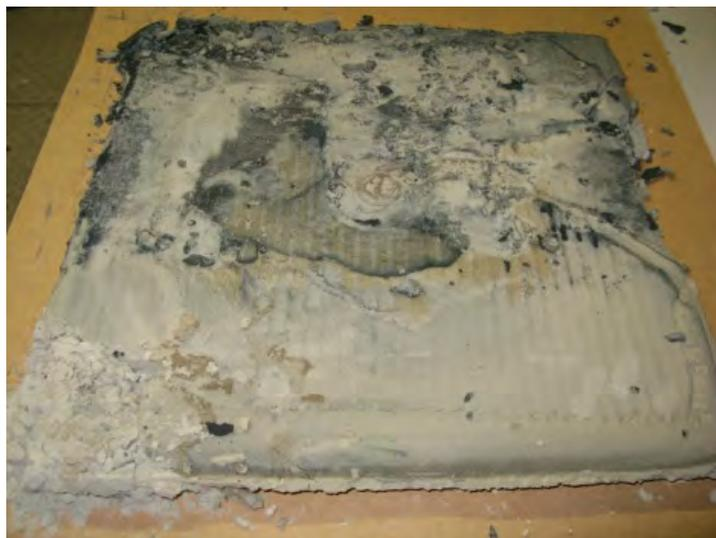
Abbildung 3.27: Produktkuchen nach Entnahme aus Kammerfilterpresse
