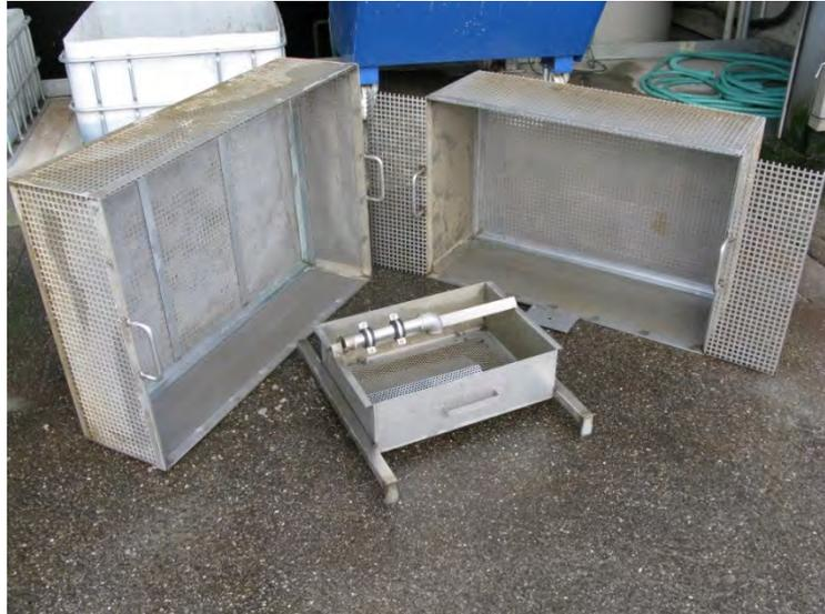
Abbildung 3.22: Metallsiebkörbe zur Produktentnahme
