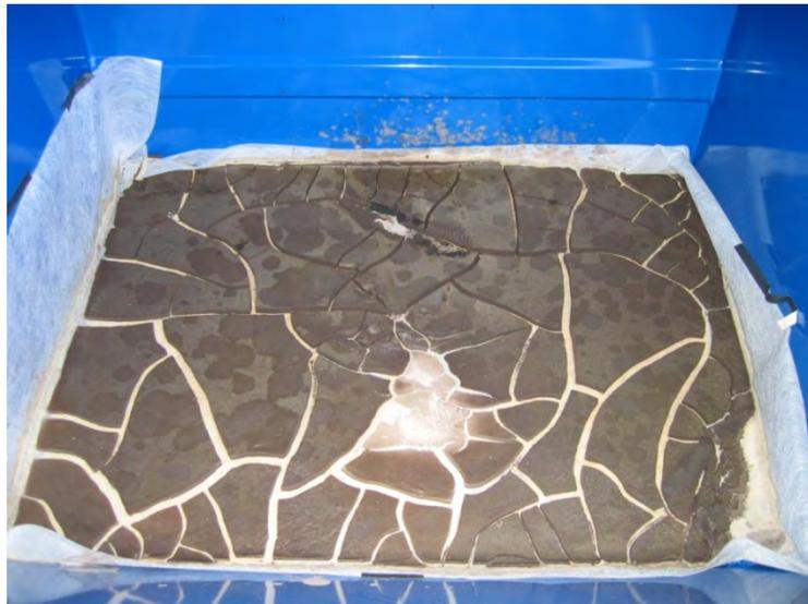
Abbildung 3.21: Gewebesiebeinlage mit beginnender Produkttrocknung
