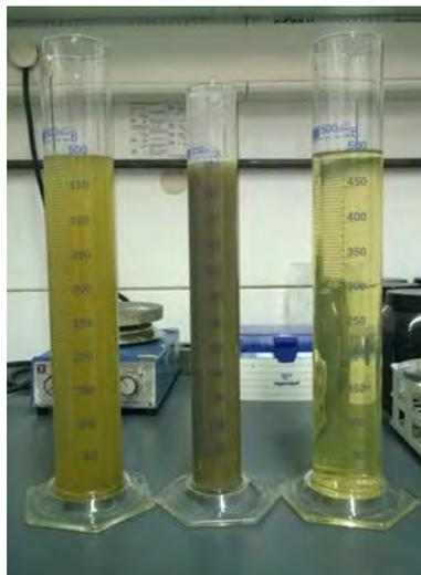
Abbildung 2.15: Laborversuche zur Vorreinigung des Filtrats aus der KFP (mittlerer Standzylinder) durch Sedimentation (linker Standzylinder) und Ultrafiltration (rechter Standzylinder)
