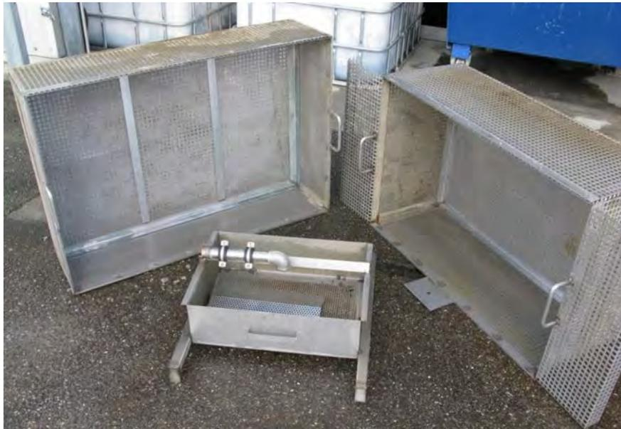
Abbildung 2.21: Filterkörbe zur Abscheidung von MAP (2013)
