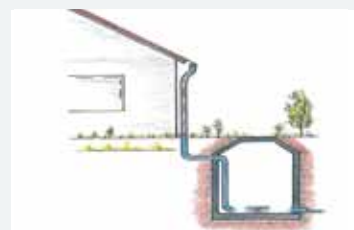
Rückhalteanlagen mit Drosseleinrichtung
