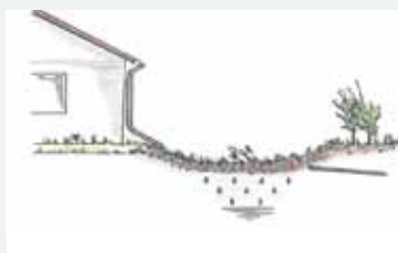
Versickerungsanlagen mit Notüberlauf
